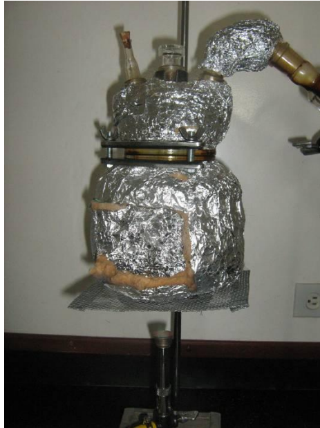
Figura 19. Reactor y conexión Reactor-Condensador aislado térmicamente, prueba N° 2 y N° 3.
