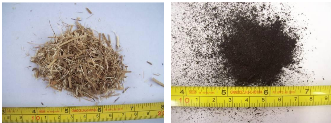
Figura 44. Muestra de la biomasa RAC antes y después del proceso transformada en biochar.
