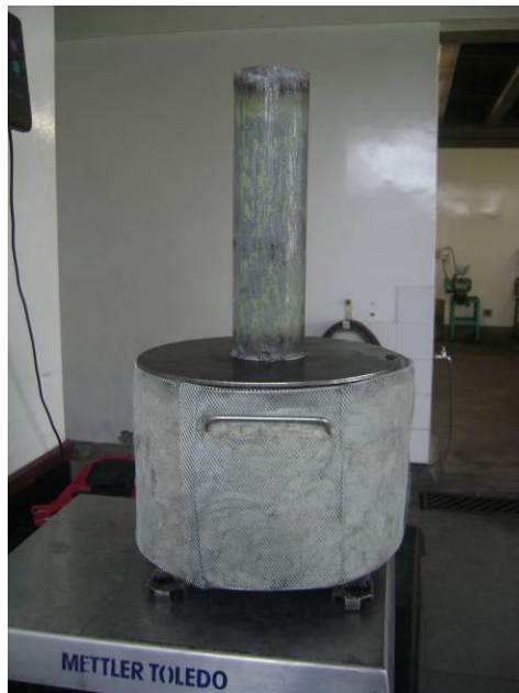
Figura 42. Equipo de pirólisis batch, para producción de biochar, Fabrica-Cenicaña.
