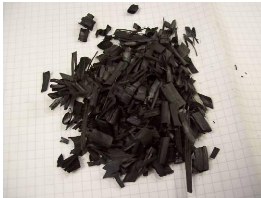
Figura 17. Muestra del char obtenido en la prueba experimental N° 1.
