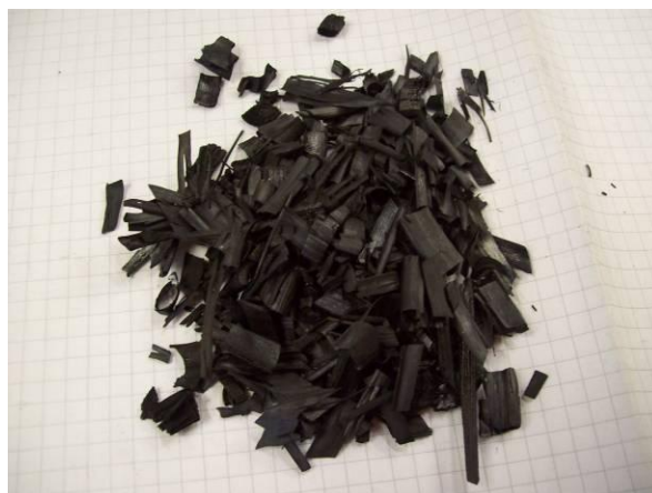
Figura 9. Muestra del Char obtenido en la prueba experimental de Pirólisis en el laboratorio de Cenicaña.
