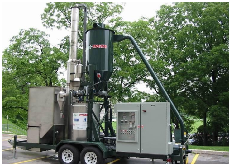
Figura 3. Unidad Móvil de Pirólisis de Biomasa [15].
