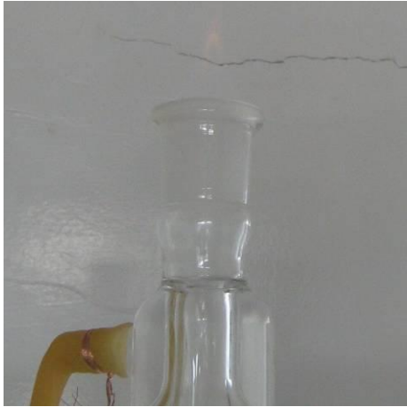
Figura 21. Gases no condensables en combustión a la salida del sistema de condensación, prueba N° 2 y N° 3.
