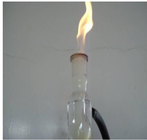
Figura 21. Gases no condensables en combustión a la salida del sistema de condensación, prueba N° 2 y N° 3.
