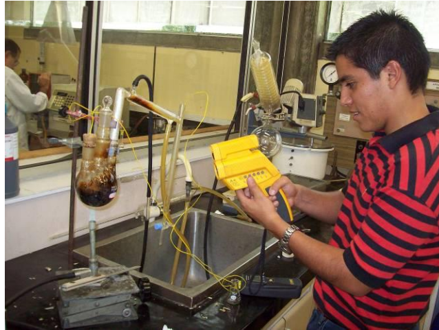
Figura 16. Medición de temperatura, prueba N° 1.
