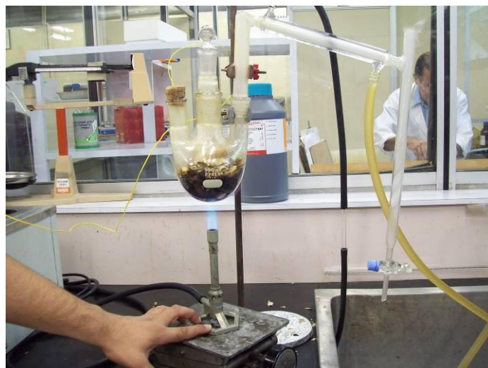
Figura 14. Montaje experimental prueba N° 1, para la Pirólisis del RAC.
