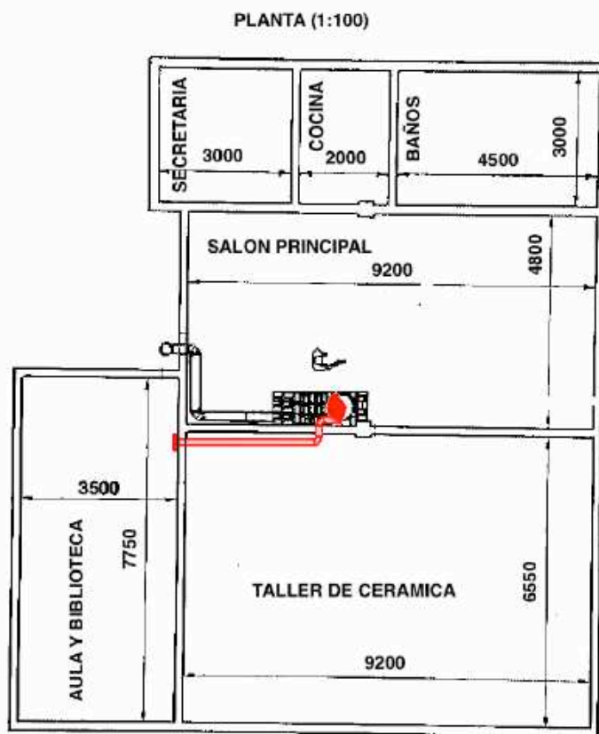
Ilustración 14. Plano de la propiedad y distribución de estufa e intercambiador.
