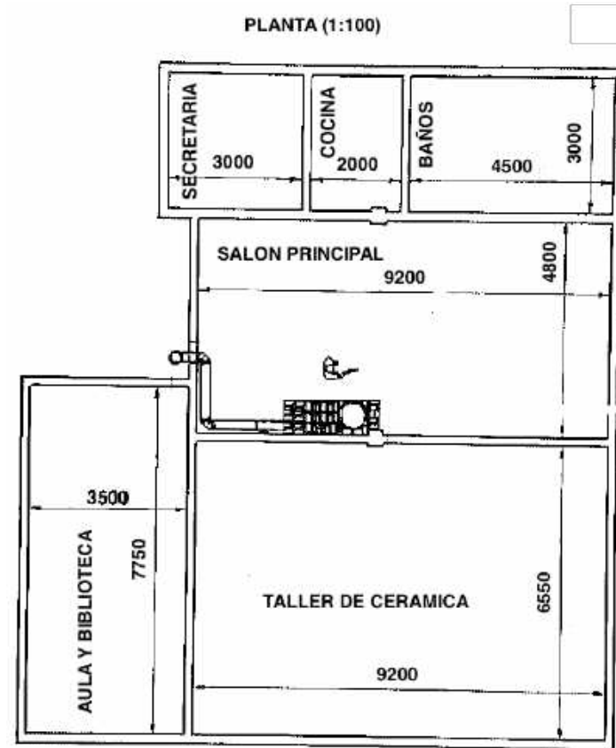
Ilustración 6. Plano de sociedad de fomento y disposición de estufa Rocket en Salón Principal
