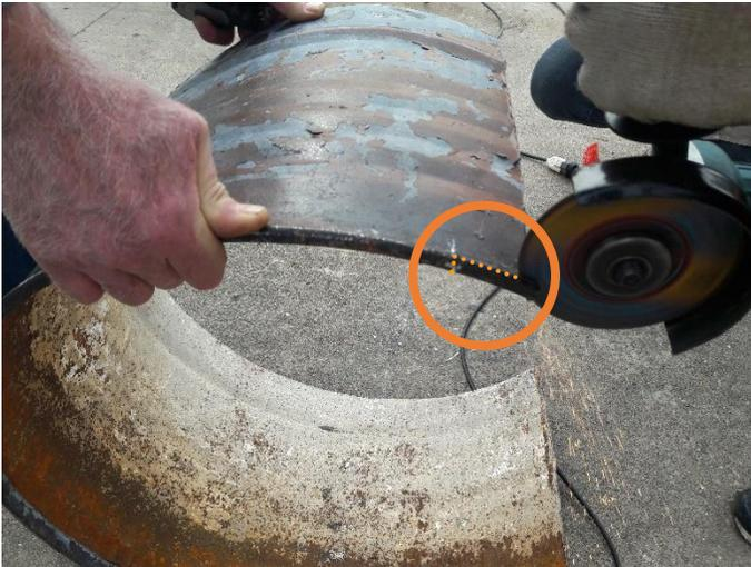
Extraemos 3 cm de la pestaña de un lado para facilitar el solape posterior
