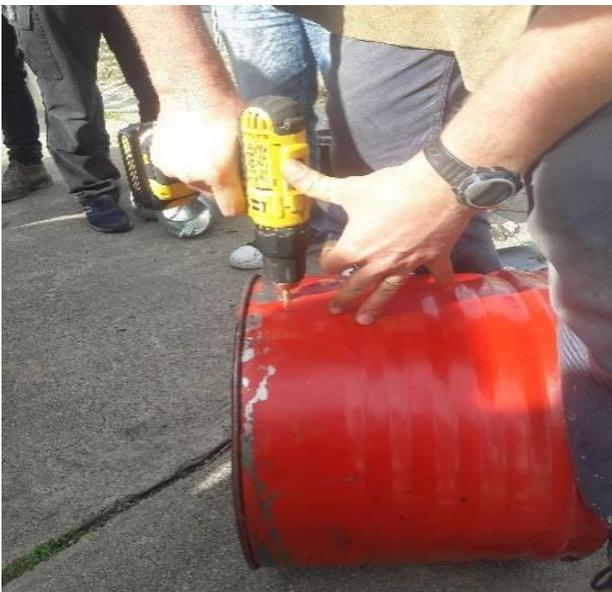
Perforamos con mecha chica para iniciar el agujero, y luego con una mecha de 10mm para que pase la varilla roscada de 3/8" (en Argentina el uso de tornillería en sistema imperial es más económico que tornillería en sistema métrico)
