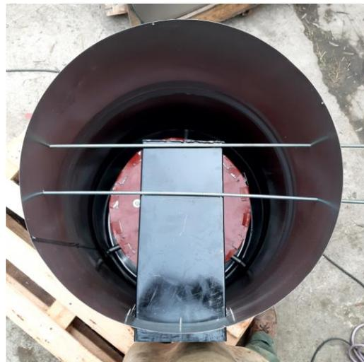
Fijar la cámara de combustión con dos varillas roscadas de 5/16", con tuercas y contratueras a cada lado del tambor, cuidando de no ovalizarlo.
