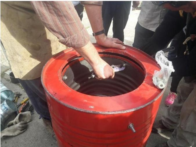
Verificamos que la varilla roscada quede al ras de la tuerca en el lado interno para que no roce la olla al ser insertada.
